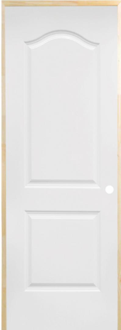
La puerta 2 PANELES HDF Decosint Palace es una puerta de diseño moderno y decorativo. Está compuesta por un bastidor de madera pino, relleno poliestireno expandido, dos planchas decorativas y marco de Pino finger joint .
